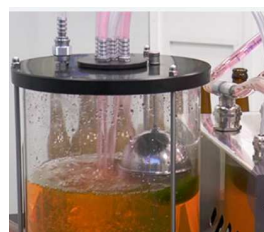
Tanque de Recuperação de Líquidos
